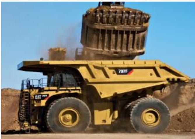
**Figura 2.** Camión minero 797F – Cat. Tomada de “Ficha técnica de Caterpillar” (26).
